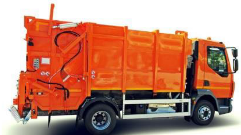
Слика 10-5. Типски камион смећар са потисном плочом
