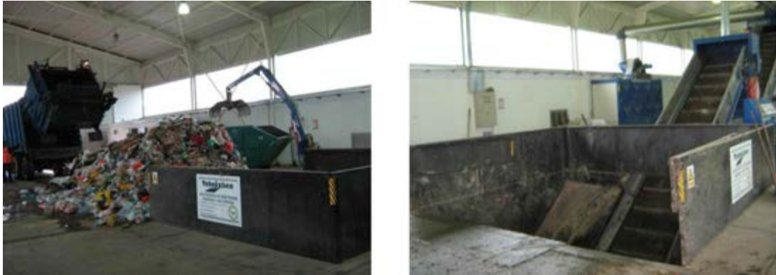
Слика 4.6.3-5. а) Истоваривање мешаног комуналног отпада у прихватну комору; б) прихватна комора са транспортером
