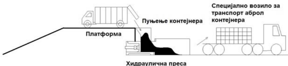
Слика 17.2.1-2. Принцип рада на трансфер станици – платформа за аутоматски истовар
