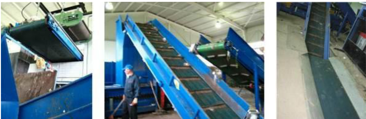
Слика 4.6.3-11. Излаз сортираног отпада из сортирнице и коси транспортер који транспортује отпад из сортирнице и из боксева са сортираним отпадом до пресе – балирке
